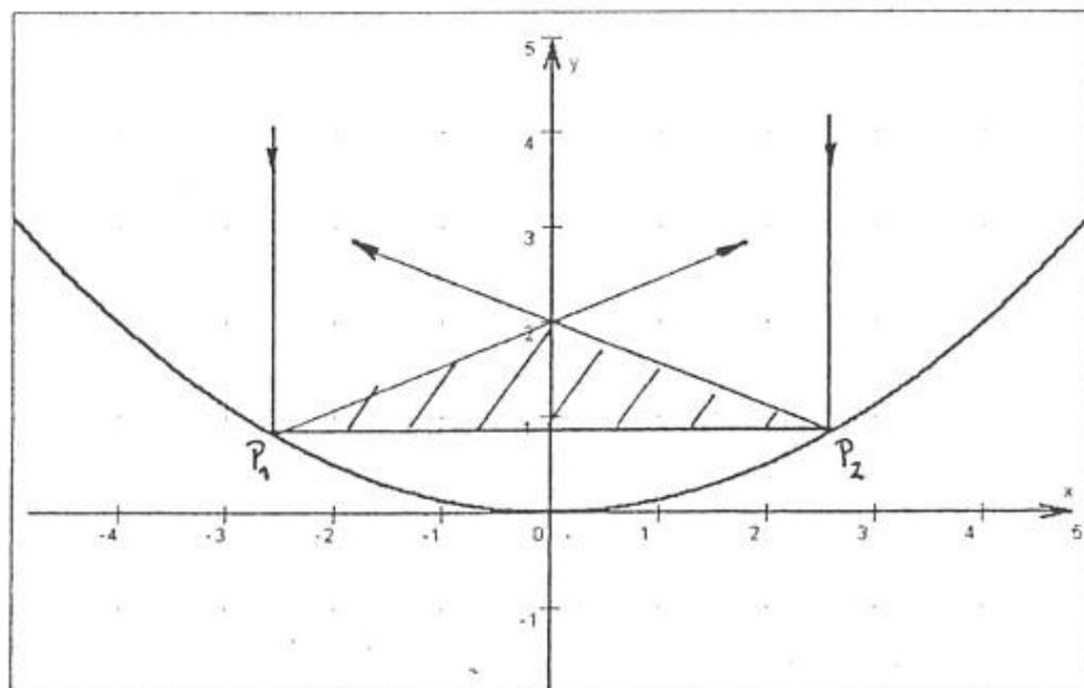
Überlegungen einer technischen Realisierung verlangen, dass die in der Abbildung schraffierte Fläche maximal wird.
